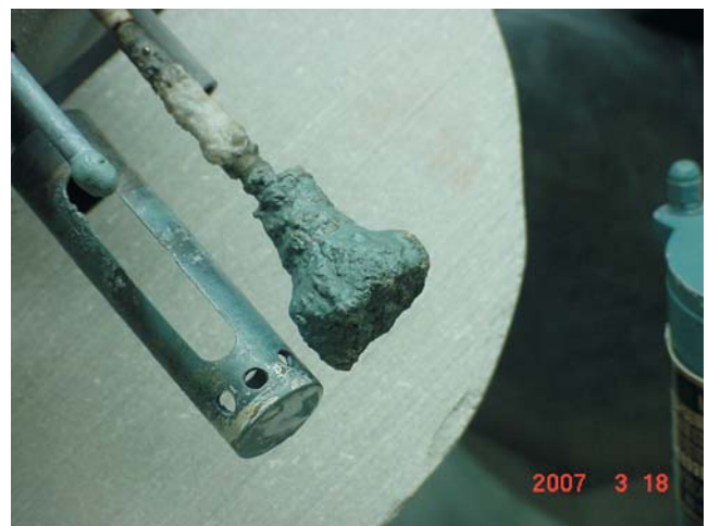
Fig. 2 : Pu metal deposited on solid cathode
